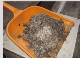
除去されたスケール
